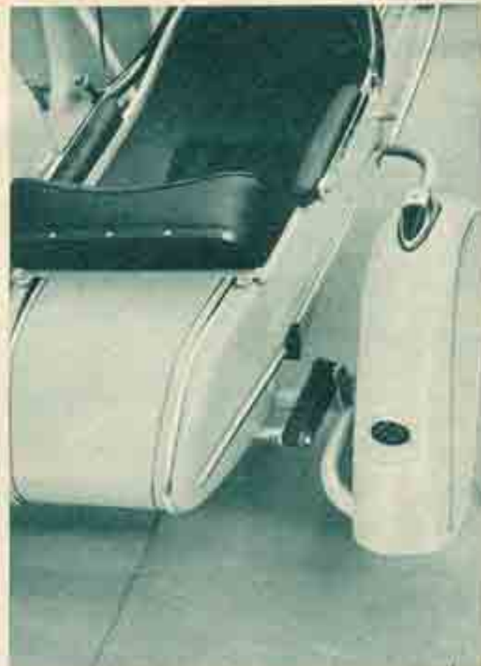
Diese Gummibandfederung der Karosse wird nicht nur bei Royal benutzt; sie hat den Vorzug größter Einfachheit.
