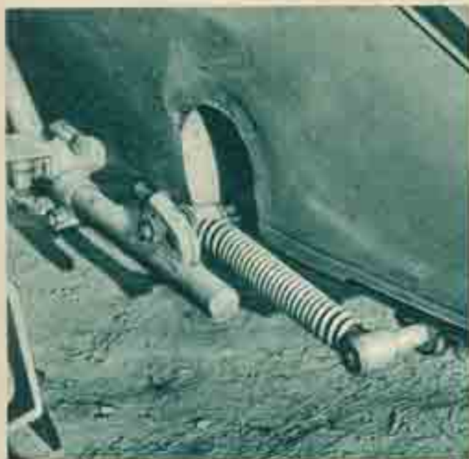
Eine Schraubenfeder ist einem Gummiband in jeder Beziehung gleichwertig, nur ist diese Schraubenfeder für verschiedene Fahrbelastungen einstellbar (Steif).
