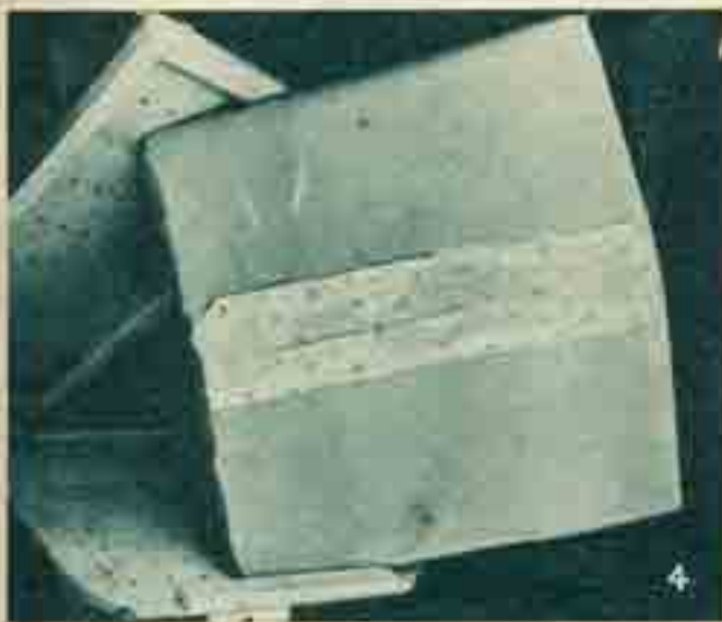
Bild 7 So wird der Bezug am sichersten genagelt, man zieht ihn also um die Kante herum, wo dies nur irgend geht, weil dadurch die Nägel entlastet werden.
