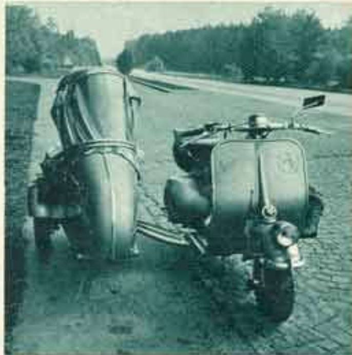
Ein solches Roller-Seitenwägelchen ist natürlich nur im Notfall für einen Passagier zu gebrauchen. Im wesentlichen soll es eben im Winter das dritte Bein auf den Boden bringen.
