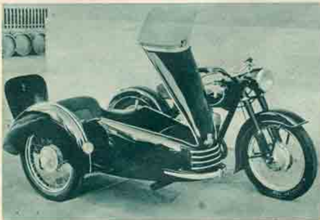
Genau wie bei Kall ist auch bei Binder der obere Karosserieteil zum bequemeren Einstieg aufklappbar.
