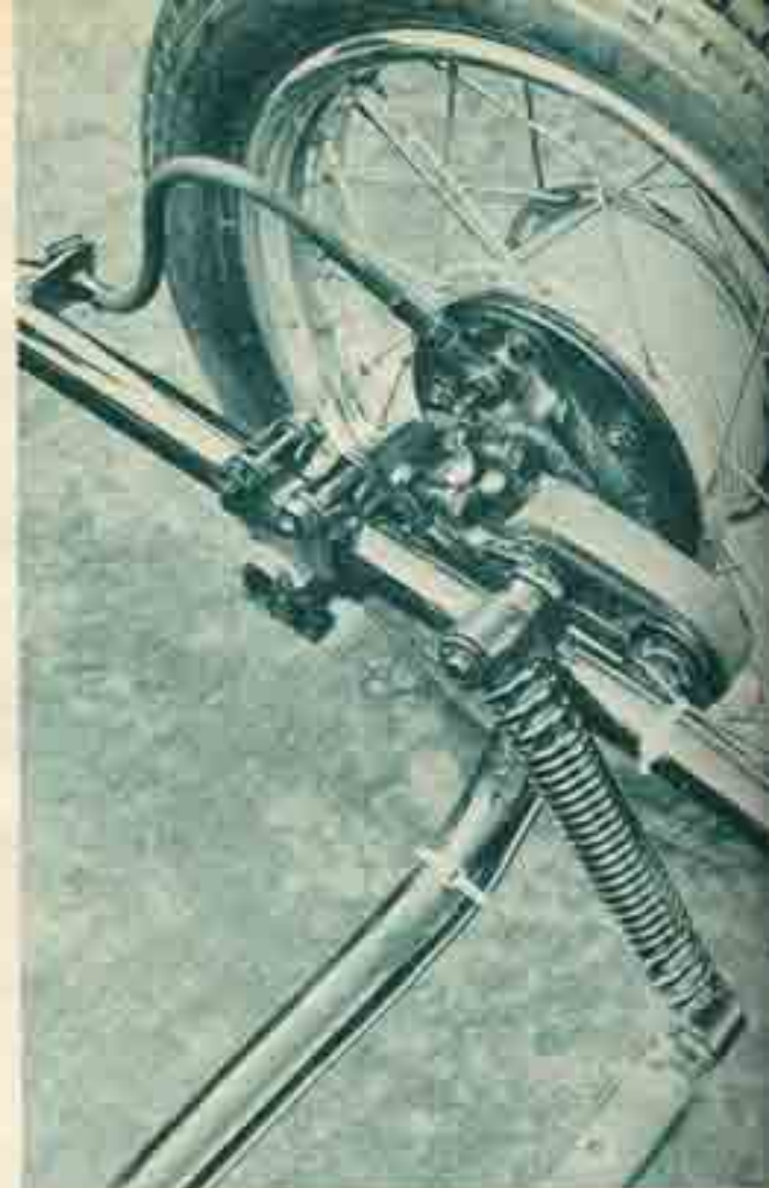
Links: Für den Goggo gibt es den gleichen Steib-Seitenwagen, allerdings noch im Gegensatz zum Malcomobil mit einer weiteren Stütze gegen das Roller-Fahrgestell. Der Schwingarm des Seitenrades ist in einem Gummielement gelagert.
