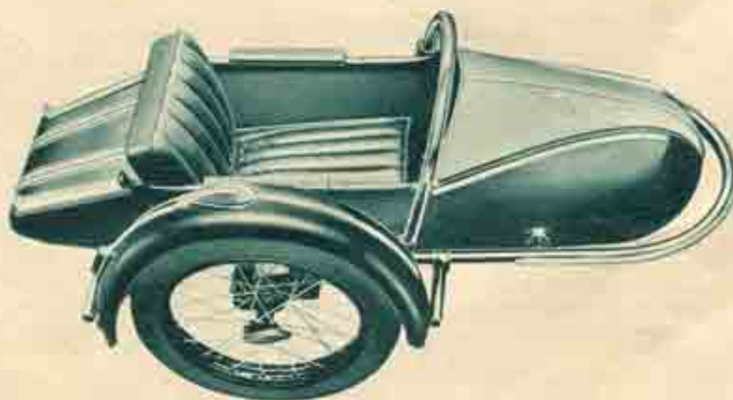
350er- Seitenwagen von Wilmssen, speziell Gummifederung der Karosse, gefedertes Seitenrad.
